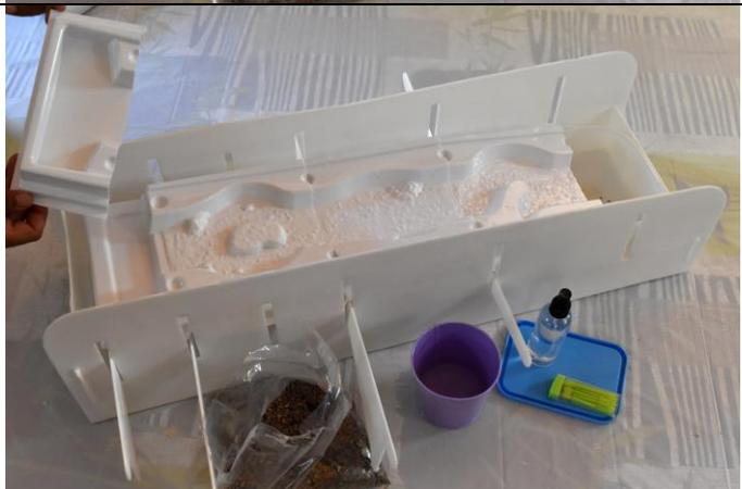
7 Ora il percorso fluviale è pronto. Agendo sulle stecche si potranno determinare pendenze diverse per ciascuna porzione. Iniziare l'esperimento con una pendenza dolce e continua.
