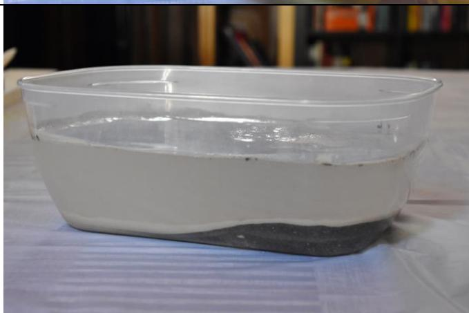
27 Continuando a trascorrere il tempo, le particelle fini in sospensione continuano a depositarsi sul fondo rendendo via via più limpida l'acqua. Il fenomeno si ripeterà alla successiva alluvione (o frana sottomarina), creando così alternanze di sabbie e argille tipiche delle torbiditi delle Langhe oppure dei *Flysch ad Helmintoidi* in Francia.
