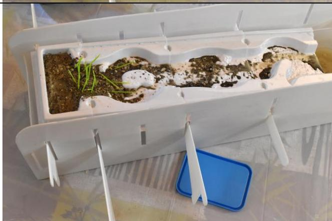
23 Ora si torni a versare l'acqua direttamente dal secchiello principale, simulando uno scroscio di temporale con conseguente alluvione. Sebbene qualche altro albero sarà caduto e trascinato a valle, ve ne saranno ancora molti dritti o inclinati, ma saldi al loro posto, impedendo l'erosione del sedimento.
