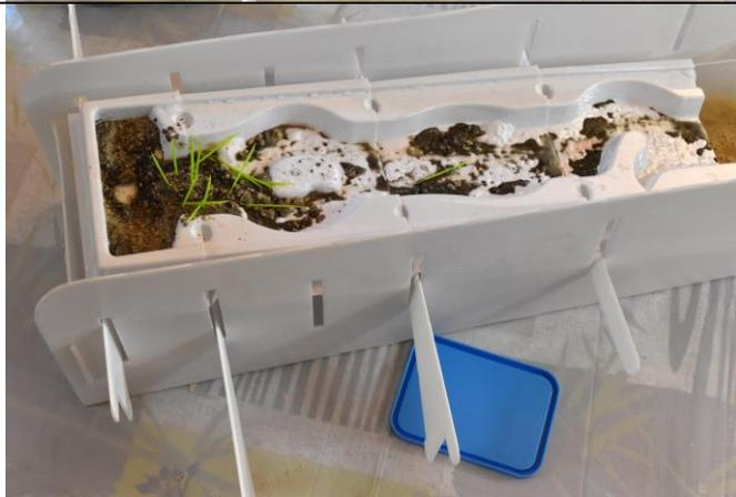
25 Adesso ci si concentri sulla vaschetta terminale che rappresenta il nostro piccolo mare o lago. Estrarla con attenzione senza dare scossoni e iniziare ad osservare l'effetto provocato da un'alluvione. Inizialmente si noti come l'acqua sia completamente torbida, a causa dell'argilla presente nel sedimento misto, mentre la sabbia e la ghiaia si siano depositate rapidamente sul fondo. Sull'acqua invece galleggia il materiale vegetale mescolato con il detrito.
