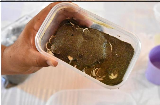
12 Mantenendo inclinata la vaschetta, se si versa altra acqua simulando un nuovo dilavamento dovuto a piogge e temporali, si nota come l'erosione riporti alla luce progressivamente le altre conchiglie sepolte.
