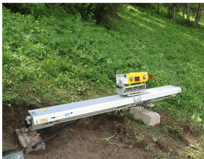
Installazione del GBInsar sul versante opposto alla frana del Pas de l'Ours (Hautes-Alpes) © BRGM
