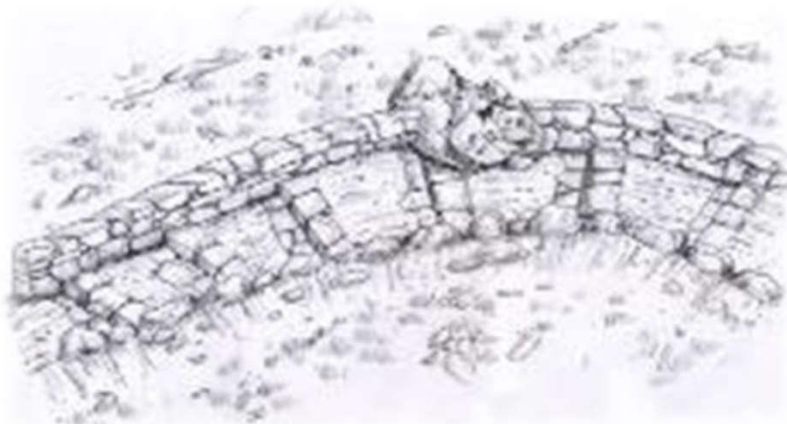
Principe de franchissement d'une restanque
