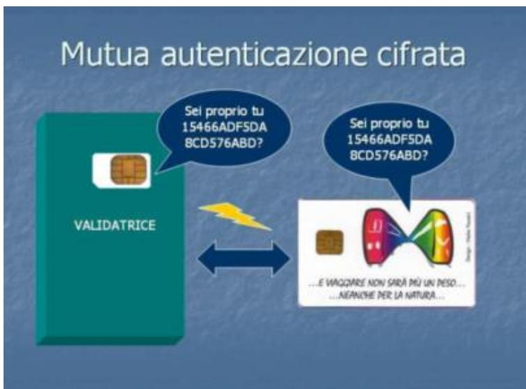
Figura 10 - mutua autenticazione smart card - terminale di validazione
