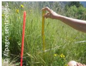
Le misurazioni dell'altezza della vegetazione vengono effettuate in 80 punti di queste linee. Queste misurazioni permettono di stimare un fitovolume (o biomassa vegetale) grazie ad una taratura effettuata nel primo anno in numerosi siti (misurazione dell'altezza, campionamento e pesatura della biomassa in parallelo).
