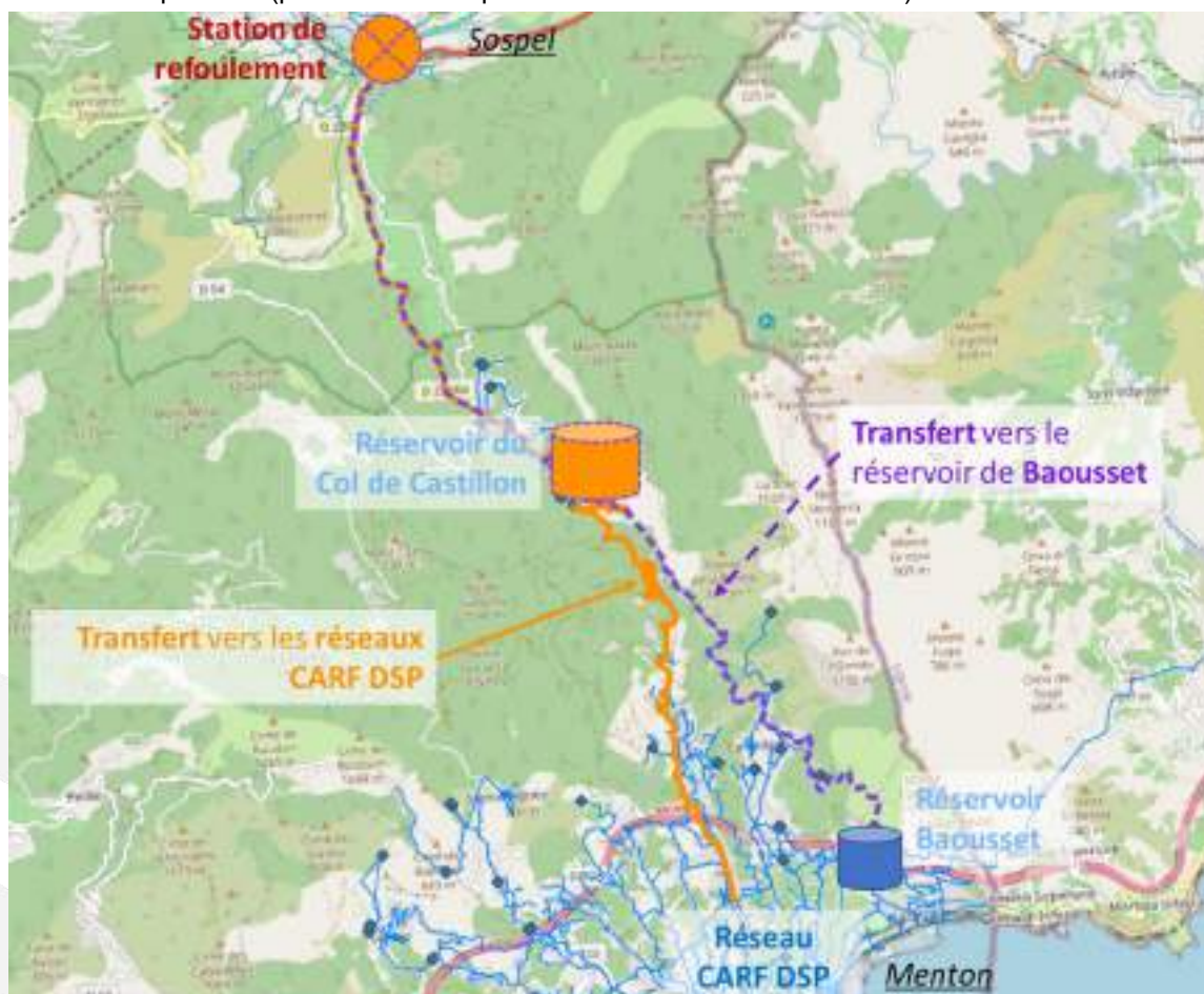
Figure 44 Carte de principe des options de transfert des eaux vers les réseaux de la CARF DSP depuis Sospel
