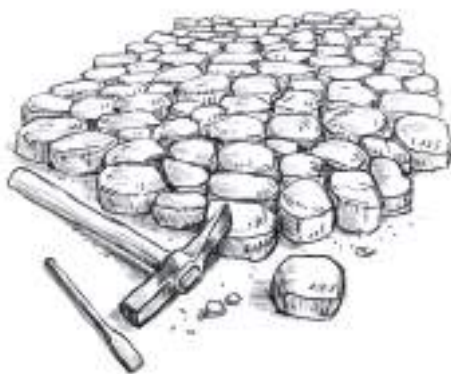
Il selciato, di pietra a secco, è un suolo che respira permettendo all'acqua di evacuare lungo le giunture.
