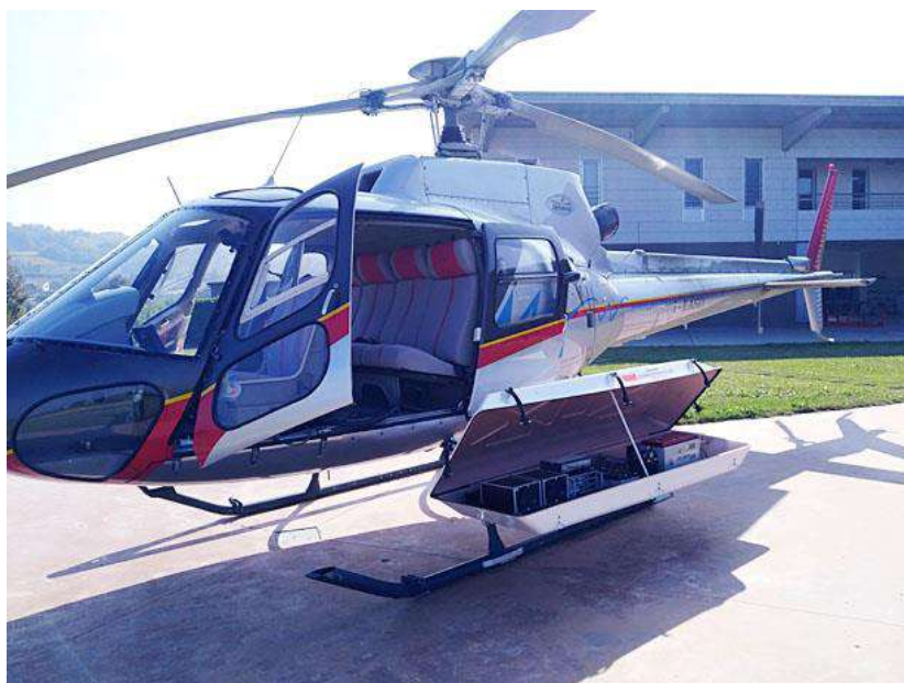
Fig. 4 – Sistema LiDAR CNR IRPI installato su AS350
