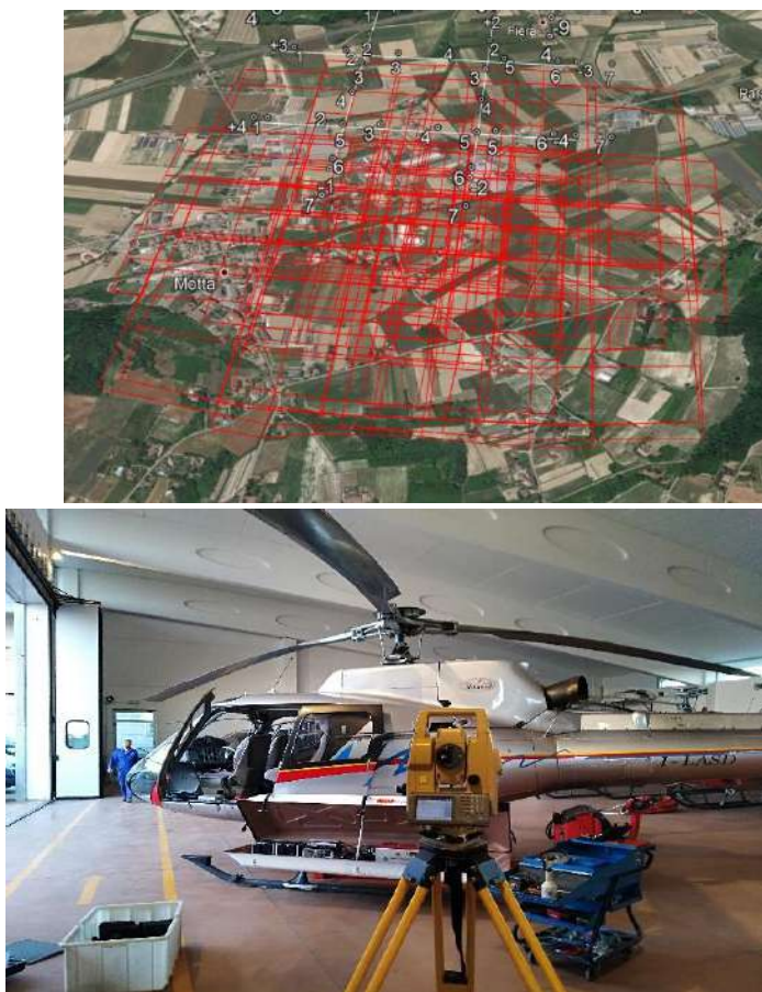
Fig. 5 – Proiezione volo di calibrazione e fasi di determinazione offset strumentali.
