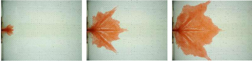
Figura 31: dall'alto, configurazione 1, 3, 2 e 4. Immagini di 3 scatti a circa 0.8s l'uno dall'altro a partire dal secondo scatto successivo al sollevamento della paratoia (modalità raffica con velocità 5 fps). L'altezza d'acqua iniziale nel serbatoio è 30 cm.
