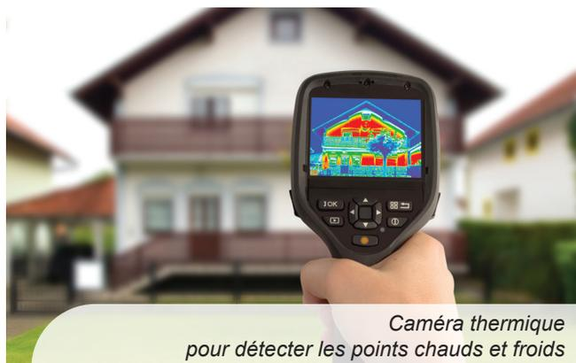
*Caméra thermique pour détecter les points chauds et froids*
